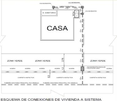
ESQUEMA DE CONEXIONES DE VIVIENDA A SISTEMA
